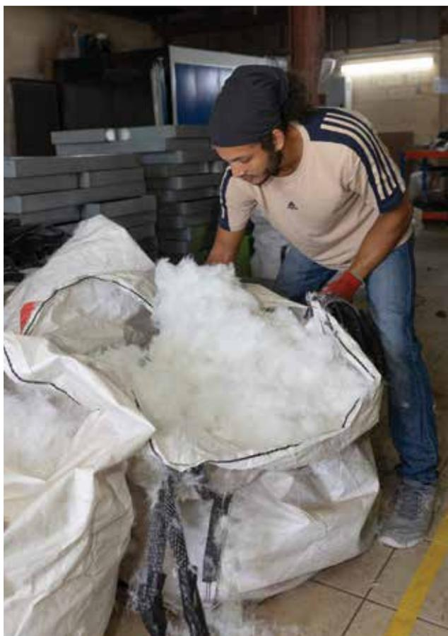
*Une fois les étapes du défilage et du séchage faites, la bagasse est mélangée à un liant textile.*
