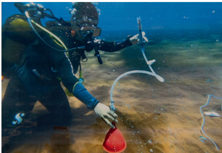
Régulièrement le gaz qui s'échappe du fond de la mer est capté et analysé en laboratoire.
