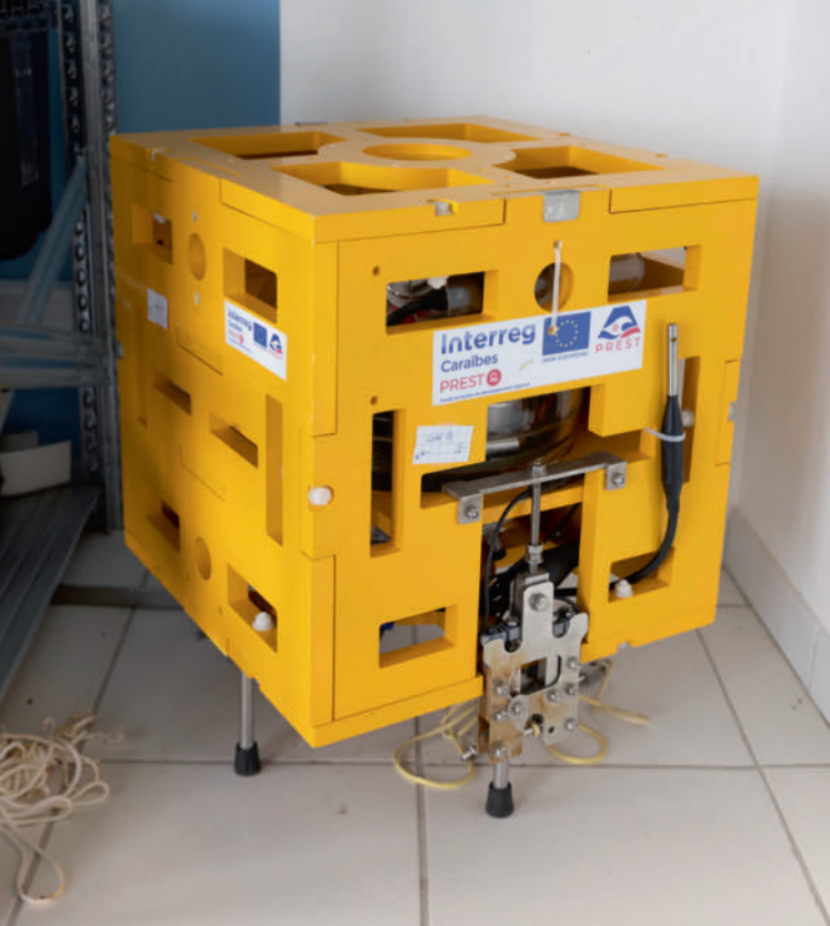
Unique prototype déployé sur les Antilles, le Ocean Bottom Seismometer permettra de faire des mesures du mouvement du sol à 2000 mètres de profondeur.
