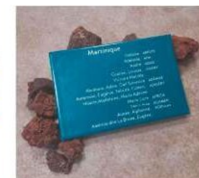
Essai d'impression sur plaque de lave émaillée
